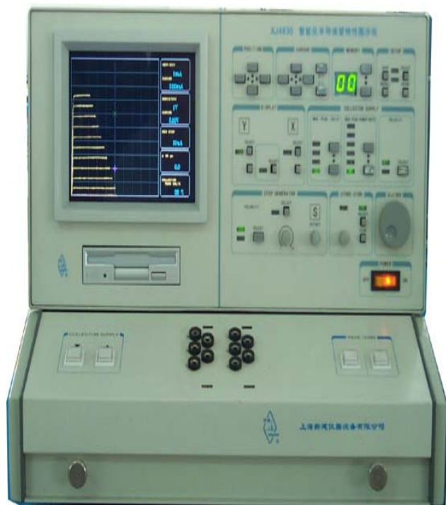
XJ4830 型智能半导体管特性图示仪主要技术指标
