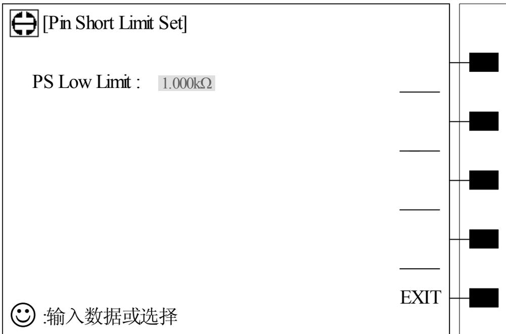
如上图，[PS LOW LIMIT]为设置判断变压器脚位短路最低极限值。
