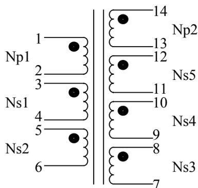
则操作如下：首先，进入[TRANSFORMER PIN SET]菜单，则此时菜单画面默认为第一组初级菜单，如上图[PRI:1]所示，此时反白发光条在变压器初级高位位置，使用数字键和[ENTER]确认键输入变压器各脚位号码即可。如下：
