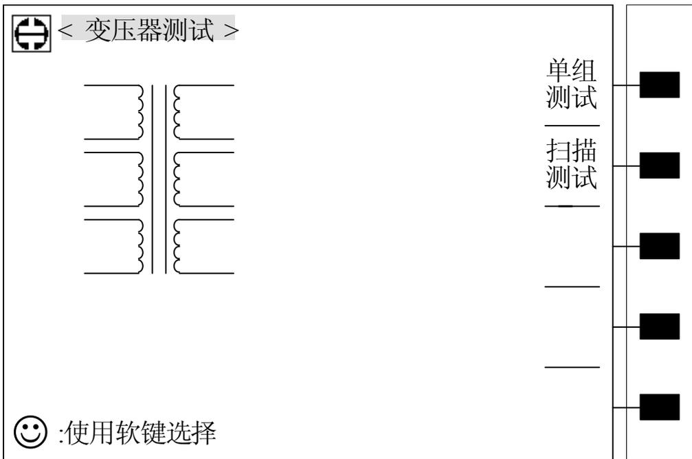
按动软键区[扫描测试]对应软键进入变压器扫描测试功能菜单画面，如下图。（变压器单组测试在 TH2818 说明书中已介绍过，这里不再重复，详情可以参照 TH2818 使用说明书）
