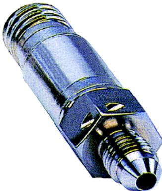
PMP3500是可同时输出数字和模拟信号的压力传感器。它所提供给客户的是独特的数字能力,高精度的输出,同时具有高带宽的模拟输出。它的综合精度指标高达  $\pm 0.1\%$  FS (在  $-54^{\circ}\text{C}\sim 121^{\circ}\text{C}$  范围内), 并能通过内部数字电路纠正重复性错误。由于内部的微处理器, PMP3500 可同时给出一组 RS485 数字量信号输出,该 RS485 接口即能用于传感器自我校准, 同时方便进行库存管理, 诸如提取系列号, 诊断等。PMP3500 内部包含 2 组独立的信号放大电路, 客户可根据自身的需求使用模拟量或数字量 (或同时使用模拟量和数字量) 输出。
