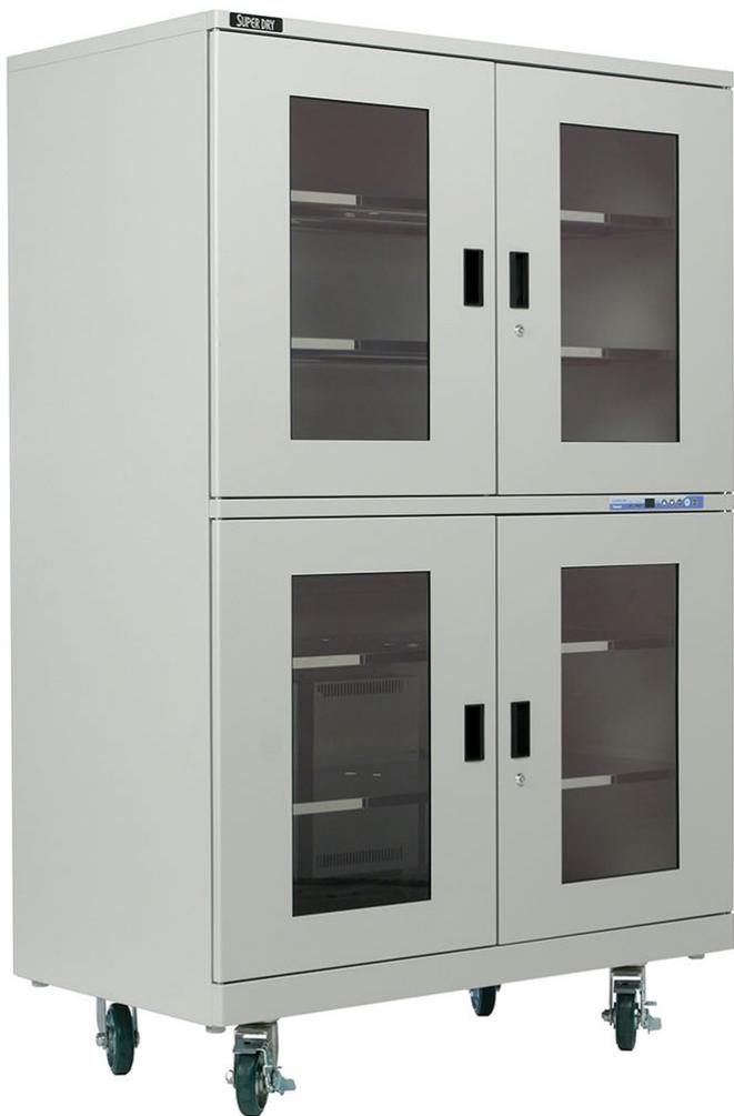
HSD-1104-01 内置两台日本原装高效除湿机芯，湿度可精确控制在1%RH以下，实现了快速除湿，适合广泛应用于各类环境。特别适合湿敏元器件及PCB的存放，符合IPC/JEDEC J-STD-033C对于湿敏元器件存放的要求。
