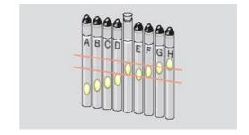
气泡粘度管可被用来快速测量已知流体如树脂和清漆的运动粘度。密封的液体标准的粘度具有永久的稳定性;清洗样品试管快速而方便,玻管没有流嘴,不会产生堵塞或是错误测量;在温度控制的情况下,很容易读取到重现性好的读数。
