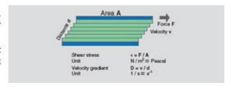
牛顿流体双面模型表明剪切应力  $\tau$  与流层方向的速度梯度的比值,这被称之为动力粘度。
