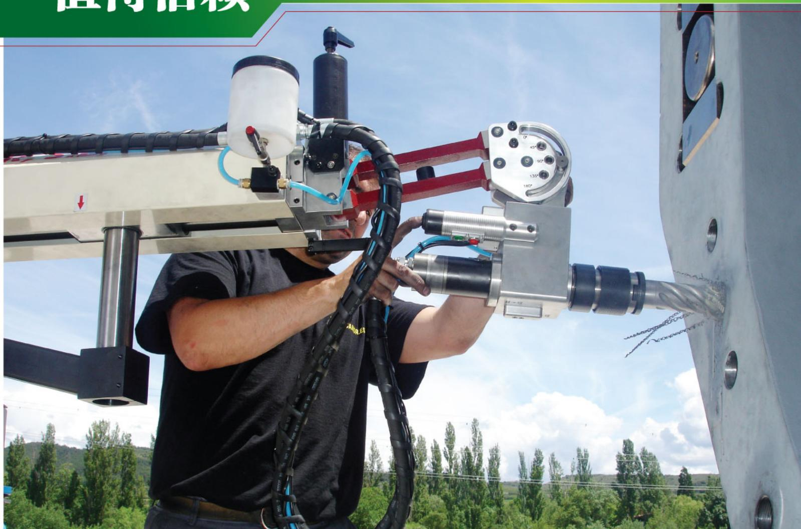
西班牙Gamor公司是一家专业研发生产大型液压攻丝机的工厂。公司自主研发生产的GAMOR液压攻丝机在攻牙能力和精度方面为世界领先水平，用户目前已遍及全球，为世界名牌产品。适用那些对攻丝精度要求高、工件巨大、攻丝孔径超大、追求效率的用户。最大机型攻丝范围：M3-M130；螺牙精度可达6H；免维护；是加工精度和寿命的保证。
