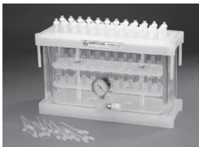
**反相萃取小柱: 从水溶液样品中萃取非极性到中等极性的分析物。**
