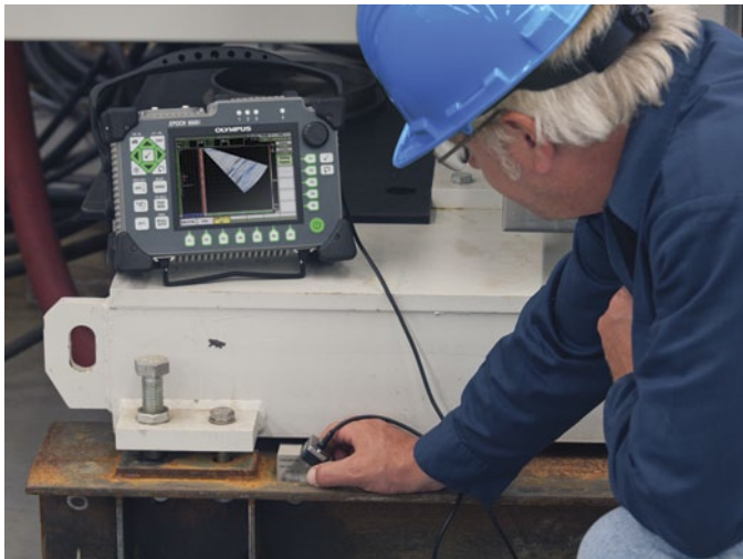
45°聚焦法则的AWS “D” 值焊缝定级显示
