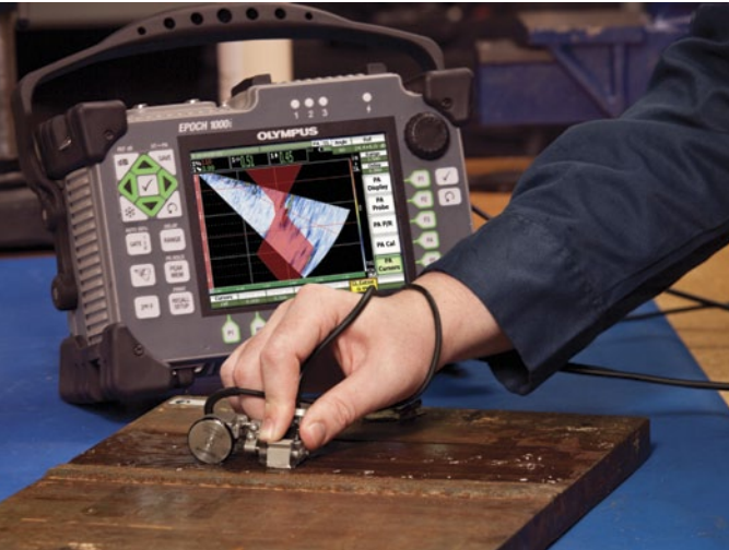
带有焊缝覆盖的相控阵S扫描
