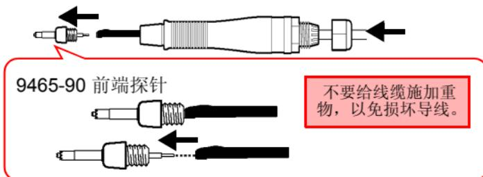
5. 扣紧新探针。将探针尖压在一个硬板上，让它不可以转动，把连接部分接在探针上。
