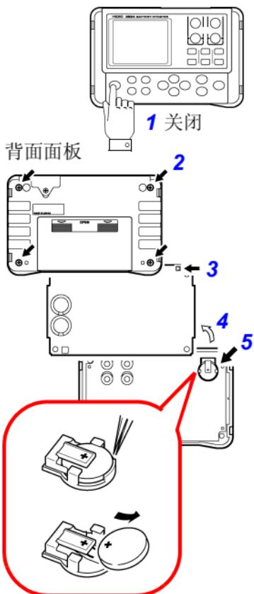
1. 关闭仪器电源, 并取下测试线。
