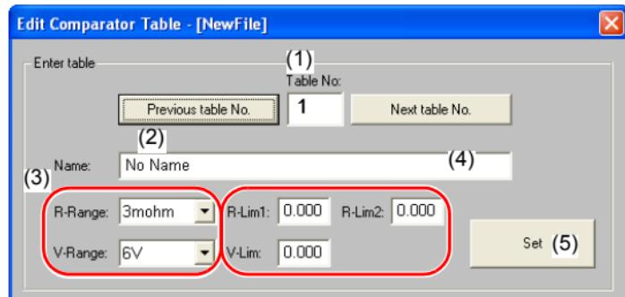
(在上图中，设置电阻第 1 上限为 130.0 mΩ、电阻第 2 上限为 140.0 mΩ[ 量程 300 mΩ] 和电压下限为 1.500 V[ 量程 6 V])
