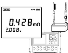
1. 将测试线连接到被测物上。
