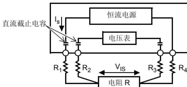
$R_1$  至  $R_4$  的值是测试线的内阻加上接触电阻的值。
