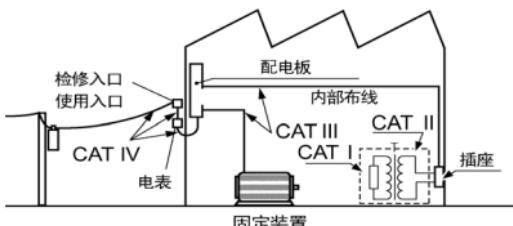
类别编号越高，对应地电气环境的瞬间能量就越大。设计用于 **CAT III** 环境的测量装置比设计用于 **CAT II** 的装置能够耐受更大的瞬间能量。
