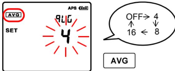
在大约 1 秒钟后无设置，将保存所显示的设置，仪器将返回到测试显示屏。
