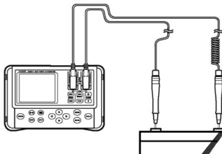
测试以后，使用附带的 USB 线缆将仪器连接到个人计算机，测试数据可以下载到计算机中。
