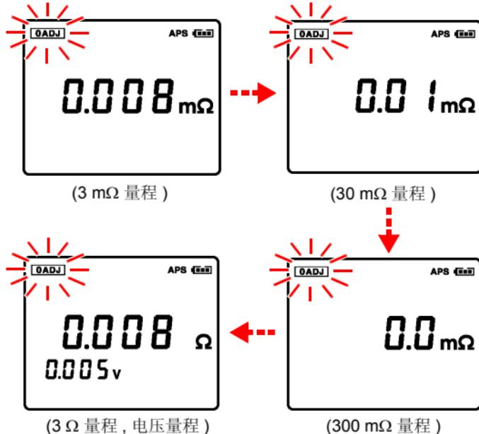
保持测试线短路，直到调零操作完成。
