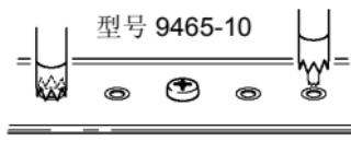
如果测试线没有被短路，显示屏闪烁，显示出错信息。
