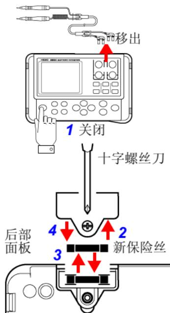
1. 关闭仪器供电电源，并取下测试线。
