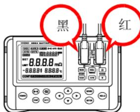
当使用选件中的 9460 带温度传感器的夹型测试线，应将小型插头连接到 TEMP. SENSOR 端口。“第 3.7 节温度测试”（第 51 页）。
