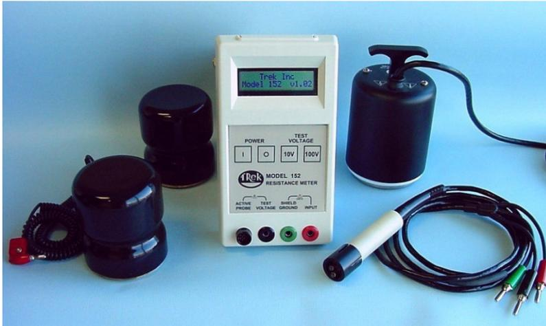
Trek Model 152 面电阻测试仪是用来精确测量各种传导、损耗、绝缘的面电阻，Model 152是采用了几种ESD标准的测量技术来进行面电阻和面电阻系数的测量，包括采用S2.1标准对静电衣的测量，S4.1标准对工作环境表面的测量，S7.1对地面电阻的测量，S11.11对平板材料的测量。它是通过各种不同电极结构的测量探头来进行面电阻和面电阻系数的测量。
