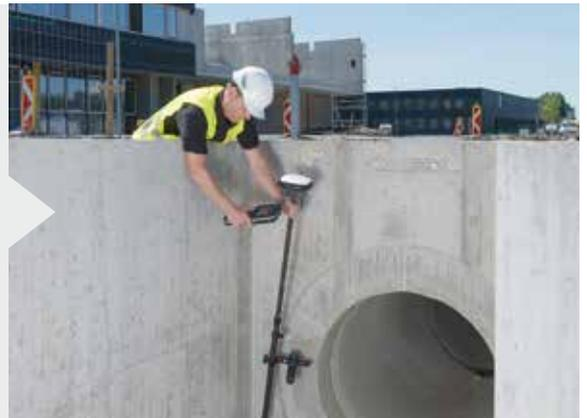
传统的RTK，测量或者放样，在工地、道路上如何保证气泡严格居中时，同时注意到头顶的吊钩、脚下的钢筋、无处不在的孔洞和身边的运转的重型机械等巨大威胁？
