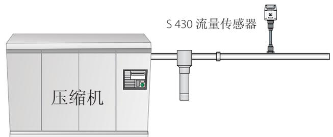
空压机排气量测量和FAD流量自动计算
