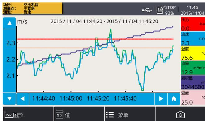
S 551采用的高分辨率5英寸彩色触摸屏界面让操作简单易行。电源开启时自动识别SUTO智能传感器。简单设定后即可开始数据记录, 存储容量近乎无限大。
