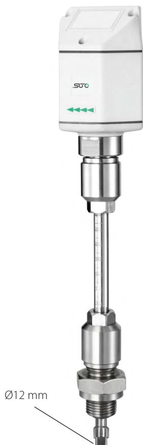
热式质量流量开关S 409可以检测流体的方向, 可以应用于压缩气体和无腐蚀性的气体。传感器部件非常坚固, 完全由不锈钢构成。通过G1/2"型球阀实现在线安装。
