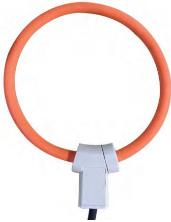
SUTO 钳形电流传感器是交流有效值测量电流互感器, 由灵活的可动部件(罗氏互感线圈)连接到一个紧凑的数字转换器, 可以测量最高到交流3000A的导体的电流。
