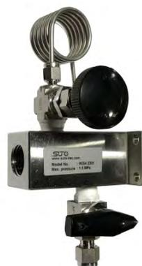
测量室，带进/出口阀和供气压力接头
