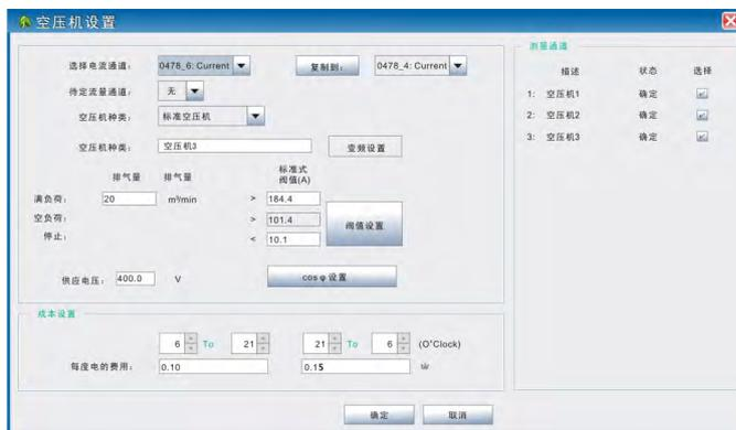
通过USB或以太网接口SUTO的S4M软件可以将记录数据下载到电脑。基本的分析可以在S4M中完成。对于更为复杂的压缩机分析CAA提供了更多的功能如：压缩机表现统计(效率, 产期量, 加/卸载循环)、泄露分析、报告生成等待。可用上一年或上一月为基准进行比较分析以诊断系统升级的效果。
