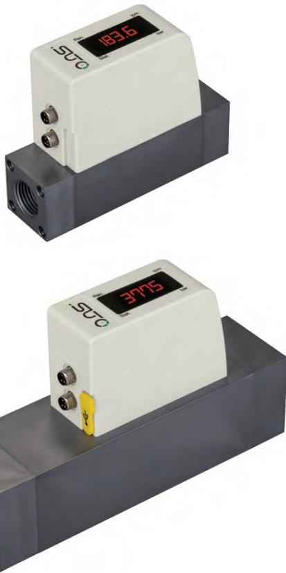
SUTO品牌S 415和S 418热式质量流量计可以直接在使用点测量气体流量和累积量，这些经济型设备可以帮助减少压缩空气使用量和运营成本，从而提高系统效率。如上两种版本的流量计均带有无线连接接口，能够通过SUTO流量计APP简单快速地查看流量计读数和调整参数。
