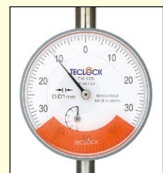
使用ダイヤルゲージ 外径φ55~φ59用 TM-110, TM-1201などに使用 できます
