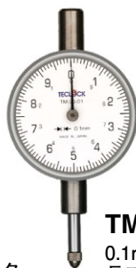
TM-91 目量0.1mmの 標準タイプ 目量0.1mm 測定範囲10mm ・ショックブルーフ
