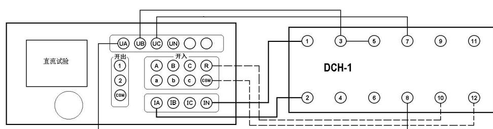
等待 15—25 秒重合闸电容充电充满、信号灯亮后，将  $U_c$  电压值改为 -110V（在输出状态中，鼠
