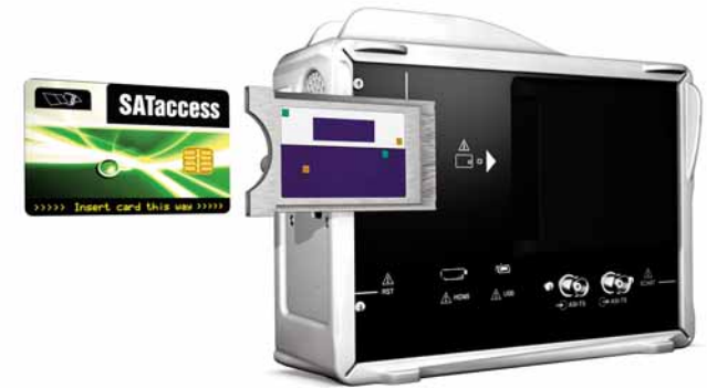
通过CAM接口解码加密频道
