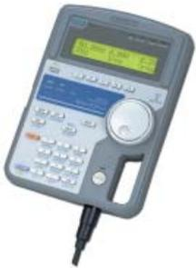
除可进行与PCR-LA系列主体面板相同的操作外，还可大幅扩展PCR-LA系列的功能。电缆长度：约2m
