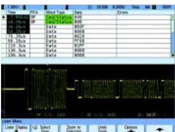
协议解码的 MIL-STD 1553 物理层信号的时间相关显示
