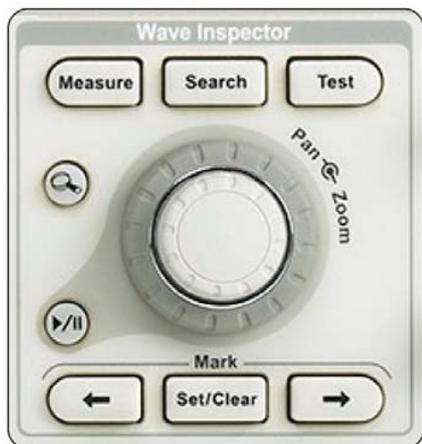
► Wave Inspector控制功能在查看、导航和分析波形数据方面提供了前所未有的效率。
