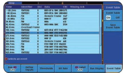
► 数据包解码表，显示了长采集中每个 CAN 数据包解码后的标识符、DLC、数据和 CRC。
