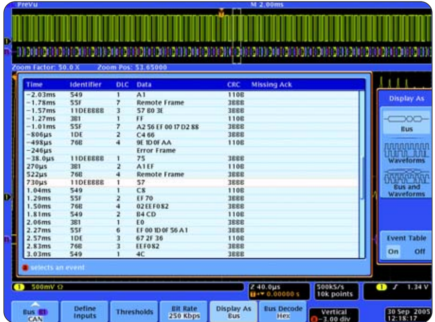
► 数据包解码表, 显示了长采集中每个CAN数据包解码的标识符、DLC、数据和CRC。
