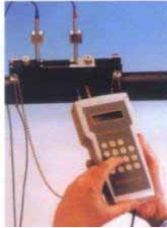
PT204、216 便携式时差式超声波流量计专门为电力行业、石化工厂、空调行业等行业细管径流量测量而设计。使用本仪器，维护工程师可以对机器运行可能发生的问题做出快速响应，并能准确的判断出问题所在。仪器体积小，重量轻，可随身携带到现场，迅速准确地测量出任何材质细管径管道的流量。
