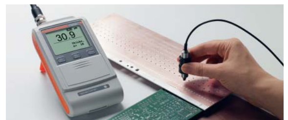
ISOSCOPE® FMP10 配合FTA3.3-Cu探头测量印刷电路板, 铜板。
