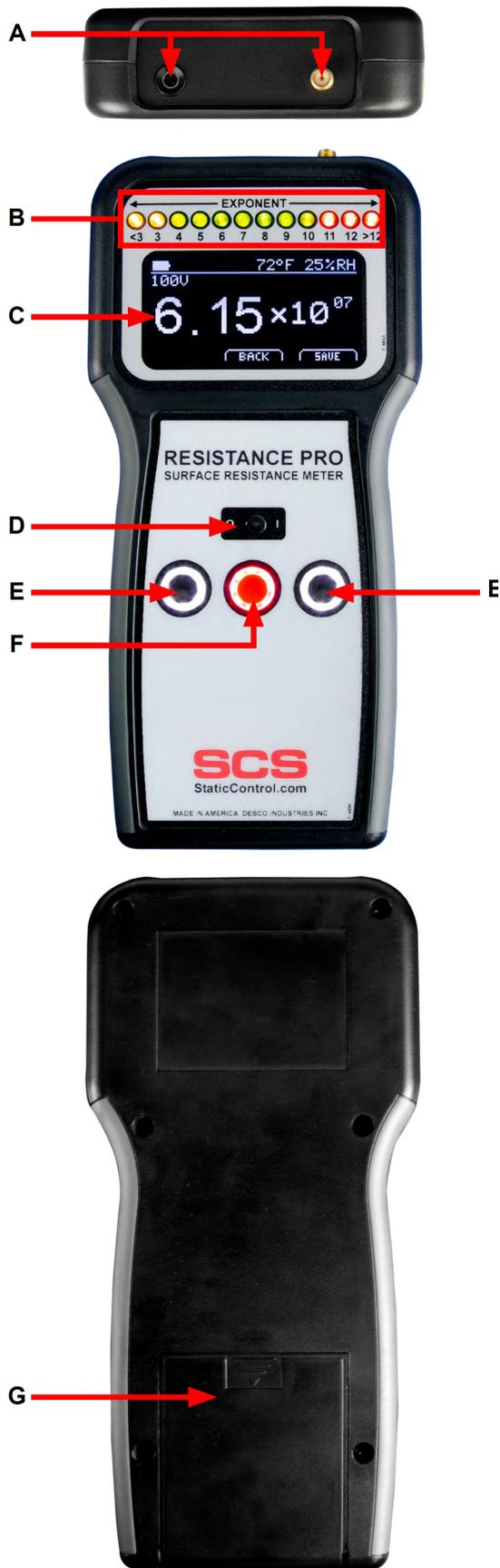
◇ A: 连接线插孔，黑色连接线插入右边 SMA 端子并拧紧，红色连接线插入左边 4mm 插孔
