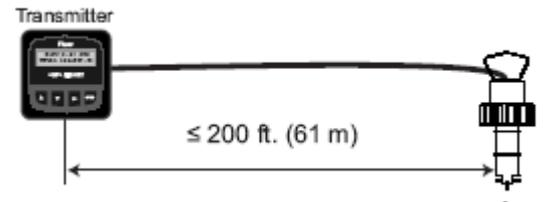
对于 2536/8512-XX, 2540/2541, 涡街流量传感器，以及任何输出方波信号的传感器，最大电缆长度为 1000ft (300m)。
