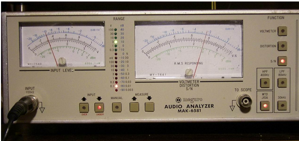
图 6-8 输出 2 伏时的 A 加权 S/N 比为 91.2dB（图 6-3），输出 1 伏时的 A 加权 S/N 比为 82.4dB（本图），输出 0.5 伏时的 A 加权 S/N 比为 73.8dB（图省略），可以看到输出电压越高时信噪比越好，输出电压越低则信噪比越差，那么测量什么状态的信噪比作为被测机器的指标好呢，根据实际上在家里听时所开的音量，其
