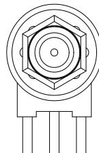
PXI触发连接器用于路由外部触发信号。触发信号可兼容TTL。PXIe7687控制器提供四种触发模式来同步PXI模块，包括：
