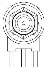
PXI触发连接器用于路由外部触发信号。触发信号可兼容TTL。PXIe7682控制器提供四种触发模式来同步PXI模块，包括：
