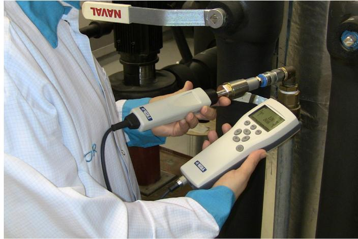
维萨拉提供手持式露点仪进行抽检和现场验证。其探头可以直接插入带压过程中，并且可以对周围环境和工艺条件快速做出反应。
