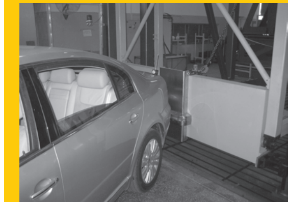
图4 对“车角”的碰撞试验
