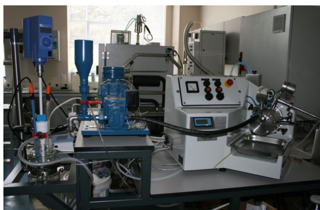
图1 在循环模式下操作的湿法研磨过程的实验装置
