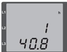
图. 测量值的工作小时表显示 UMG 96RM显示的是额定工作小时表中的140.8小时。这相当于140小时80工业分钟。100分钟相当于60分钟。在这个例子中，80分钟代表48分钟。
