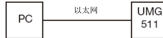
图 13.3 使用以太网连接 UMG511（带有以太网选项）与 PC。
