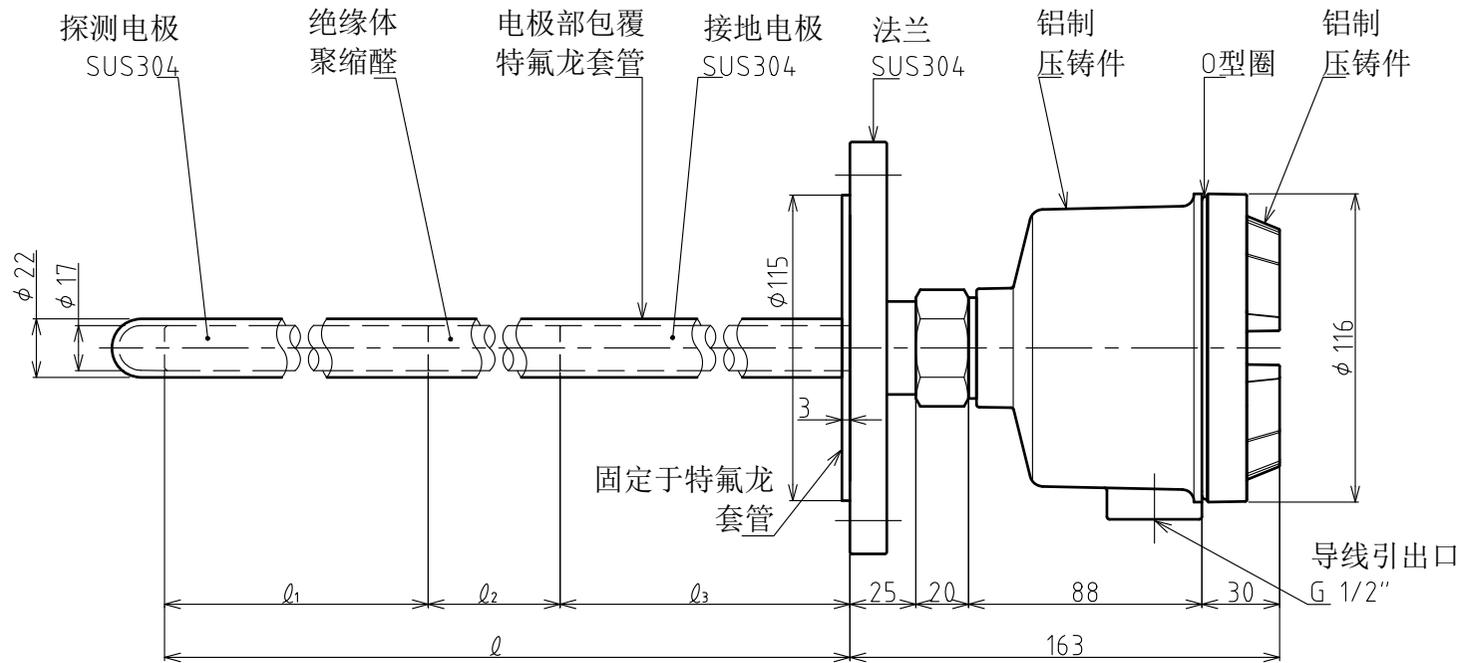
接点输出:AC250V 3A (负载电阻)
