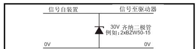
图 4-39 数字及单极输入输出过压抑制
