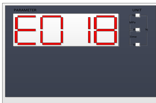
图4-5 故障告警显示状态
