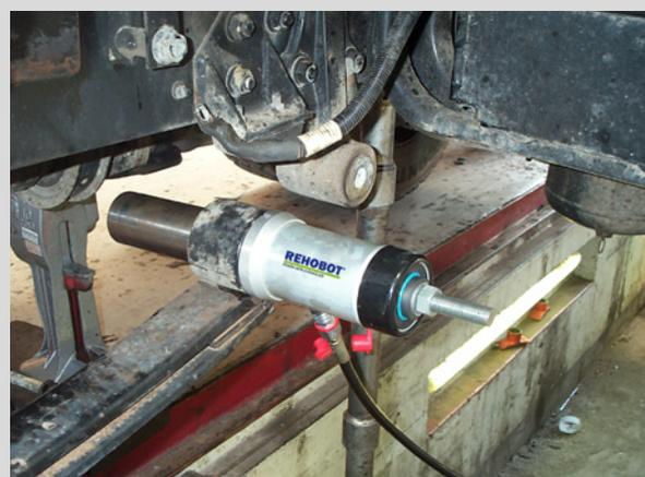
使用EBH18-工具套件来拆除旧的轴承套管，然后再插入一个新套管到DAF CF85卡车上，就这么简单。这样的操作可以以安全快速的方式完成。
