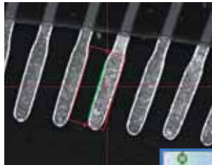
线工具 在最少一个像素间隔检测出直线形状边缘，与单点工具比可以平均化和除去异常点，能够稳定的测量。
