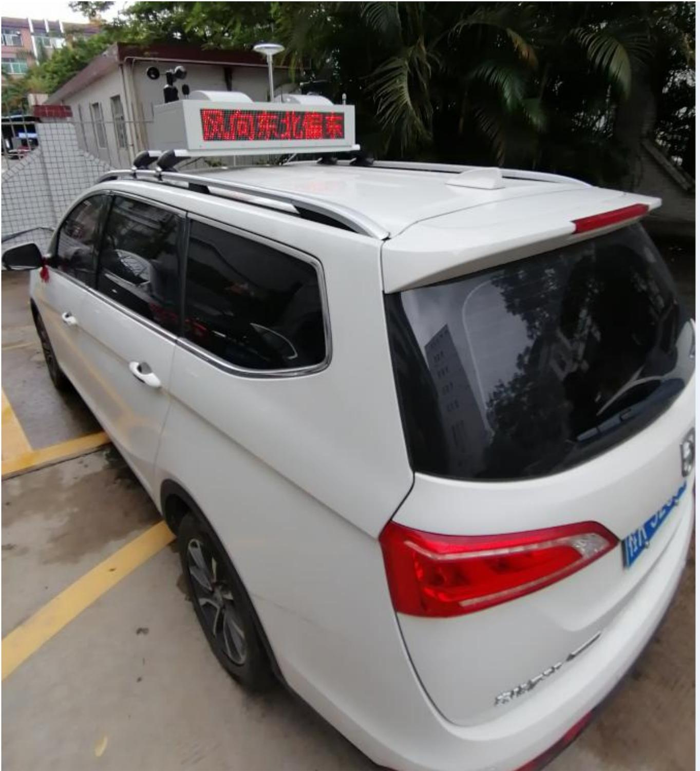
碧野千里 BYQL-CYZS 车载式扬尘噪声实时监控系统是基于 3G 移动式互联平台上开发的车载移动式扬尘自动监测设备。它集成了 H.265 编码高清视频、1080P 直播，360 度全方位旋转云台、本地手持显示、控制录像终端、4G 无线传输、远程监控监测&预警、PM2.5、PM10、TSP、噪音、温度、湿度、等传感器数据采集等功能于一体。具有 PM2.5/PM10/TSP/噪音/温度/湿度等参数的实
