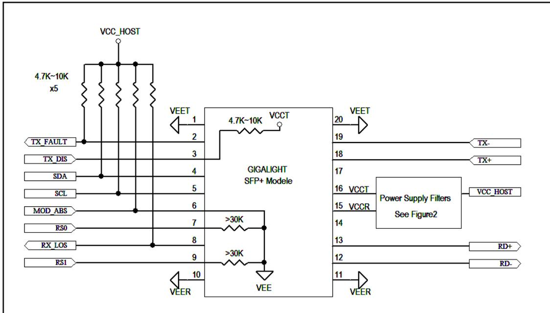
Figure3. Host-Module Interface
