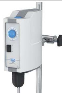
DLS可适用于中等粘度的溶液。内置显示屏，可准确显示转速，扭矩和时间；具备定时功能，可以无人看守运行。
