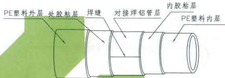
对接焊式铝塑管结构图
