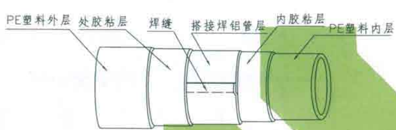
搭接焊式铝塑管结构图
