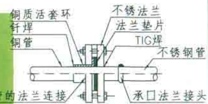
与铜管的法兰连接
