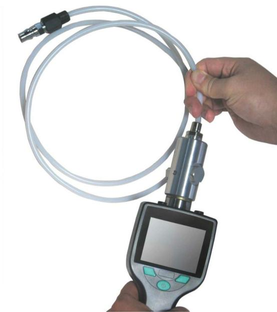
4. 将特氟龙软管与测量室连接一起。软管的一端连接在测量室 6mm 接口处。
