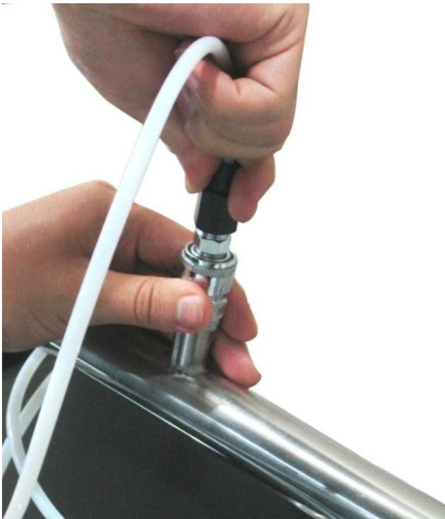
5. 把快速接头连接在特氟龙软管的顶端。它是用来将测量室接入到气体系统中。
