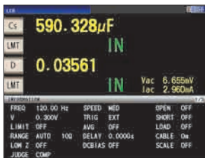
LCR模式 Cs、D显示画面(120Hz测量)
