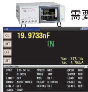
LCR 模式 Cs 显示画面(1kHz 测量时)
