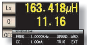
L、Q值显示画面(1kHz, CC1mA测量)
