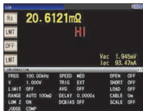
LCR模式 Rs显示画面(100kHz测量)
