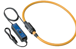
CT9667 柔性钳式传感器 AC500A/5000A, \phi 254mm, 电源: 干电池或9445-02 AC适配器 9445-02 AC适配器
