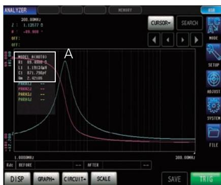
根据测量结果可以分析下面5种电路的电路元件的各成分数值(L/C/R)。
