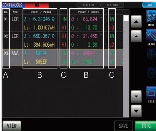
A连续测量中所设的面板No./B测量值/C各参数的判定结果
