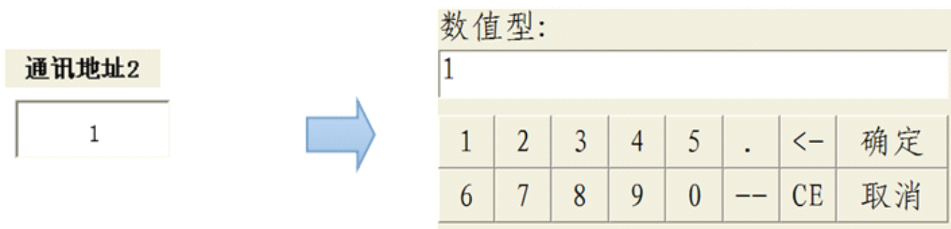
图 63 profibus 通讯地址设定
