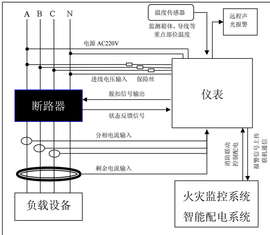
注：在安装接线时应注意剩余电流互感器的屏蔽层须接大地，若剩余电流互感器在断路器出线处不方便安装时，可以安装于断路器进线处；电压采样信号也可以取自断路器出线处。
