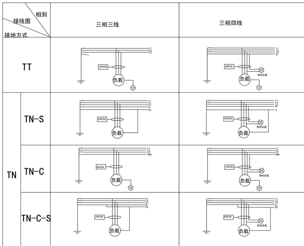
注：如上表中，剩余电流式电气火灾监控探测器安装时，必须严格区分 N 线和 PE 线，三相四线制中 N 线必须穿入剩余电流互感器。通过剩余电流互感器的 N 线，不得作为 PE 线，不得重复接地或接设备外露可接近导体。PE 线不得穿入剩余电流互感器。在 TN-C 系统中，必须先将系统改造形成局部 TT 系统，或改造成 TN-C-S 系统，再按上表接线。
