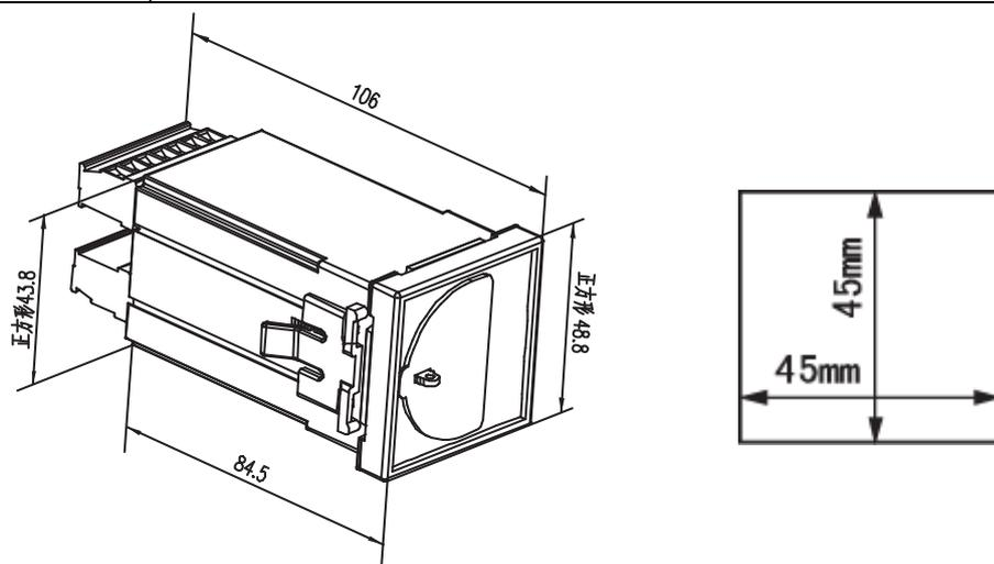
图 1 ASJ20-LD1C 外形及开孔尺寸
