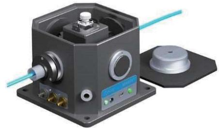
qpod2e由单个模制壳体构成。中心的反应杯支架提供温度控制和变速磁力搅拌，并且保持光学狭缝以限制光进入样品。干燥气体吹扫在低温下工作时避免冷凝。SMA光纤连接和高质量熔融石英光学器件可以以不同的组合插入位于围绕试管保持器的壁中的光学端口中。诸如偏振器和滤光器保持器的附件可以插入光路中。球面镜可以用于增强激发或发射信号。所有光学器件提供聚焦和位置调整，以最大化信号吞吐量。
