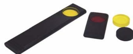
长通滤波器、短通滤波器、带通滤波器和中性密度滤光片。长通滤波器, 在短波区域具有低传输 (阻塞波段) 和长波区域中的高透射率 (通带)。范围在225nm和1000nm之间具有非常陡的透射边缘。短通滤波器的通带处于比阻塞带更低的波长。基本上, 它们阻挡更长的波长。带通滤波器, 具有由阻挡带包围的一个或多个传输带, 仅允许一部分光谱通过。它们可用于在其设计的光谱中的高透射率, 同时阻挡其他波长。中性密度滤光片 - 在特定波长范围内几乎同等地降低强度。
