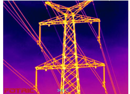
使用L07-236长焦镜头测试50米远高压塔线夹
