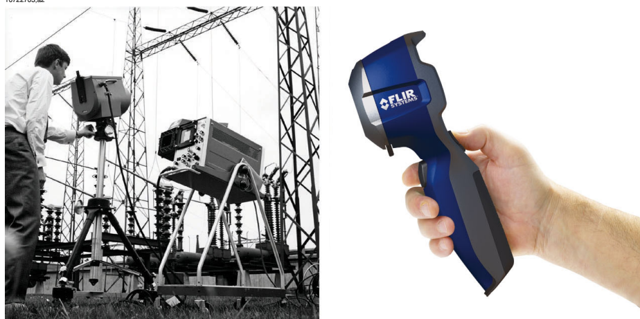
图 18.1 左图：Thermovision® 661 型诞生于 1969 年。这款热像仪重量大约在 25 千克左右，示波器重 20 千克，三脚架重 15 千克。操作员还需要一个 220 VAC 的发电机组，以及一个装有液氮的 10 升液罐。在示波器的左边，可以看见 Polaroid 配件（6 千克）。右图：FLIR i7 诞生于 2009 年。重量为 0.34 千克（包括电池）。
