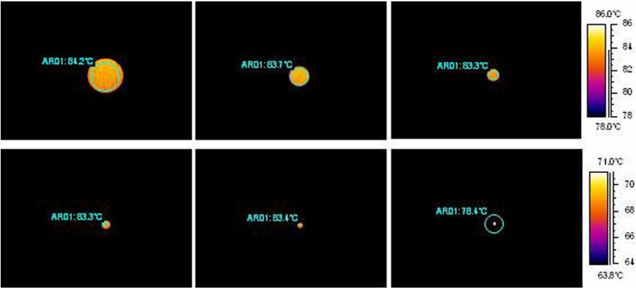
图 17.20 +85°C 下的黑体在距离增加过程中的温度读数（24 个镜头）
